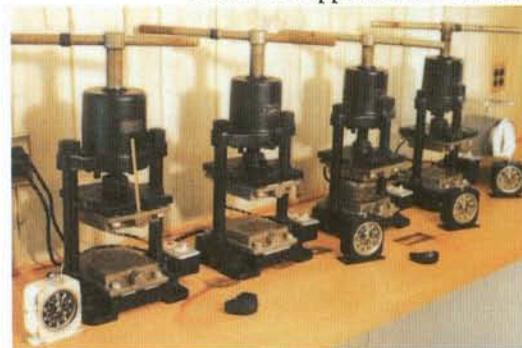
Figure 2. La presse S.S. White à air chaud sec utilisée pour vulcaniser les tooth positioners en caoutchouc. La photo est prise dans le building d'origine de Tooth Positioner (TP), installé maintenant au Centre Orthodontique.
